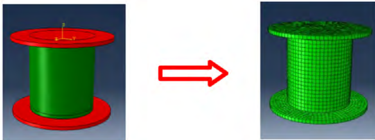
Figura 4: Modelo de elementos finitos utilizado en la plataforma ABAQUS.
