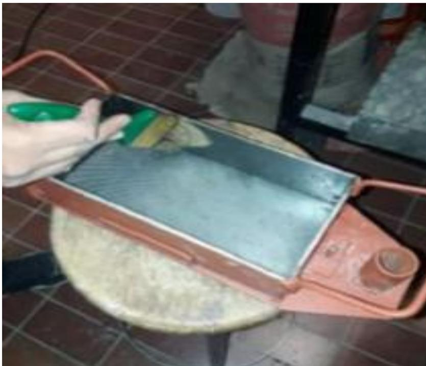
Durante esta etapa, es vital que la mezcla se distribuya de manera uniforme dentro de los moldes, para evitar la formación de burbujas de aire o vacíos como se observa en la Figura 4.
